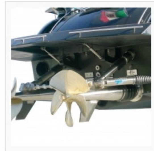
Topsystem Surface Drive è un sistema innovativo di trasmissioni di superficie ad assetto e direzione variabile per imbarcazioni plananti ad alte prestazioni frutto di un'attività di ricerca e sviluppo durata anni. Le doti peculiari delle trasmissioni Topsystem sono rappresentate dalla forma e dalle dimensioni dei drives oltreché dalla
