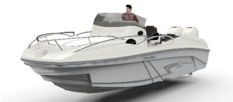
Siete metros de barco con cuatro caras diferentes. Esta es la apuesta de Rancraft que lanza RD SETTE, un barco diseñado para ser implementado en las diferentes versiones modulando los moldes. De esta manera RD SETTE se puede realizar como un **open, walkaround con cabina, un barco de pesca deportivo o para la profesional**. Además, el futuro propietario tiene una amplia elección con respecto al montaje, color, accesorios y acabados.
