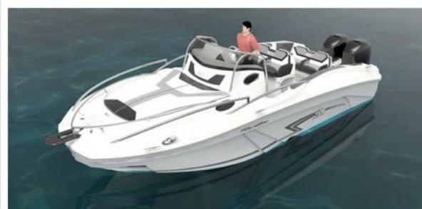
Per il particolare disegno di prua (che riguarda quasi completamente l'opera morta) ovvero la zona prodiera al di sopra della linea di galleggiamento, il cantiere ha seguito la stessa filosofia utilizzata da alcuni importanti brand d'Oltre Oceano con lo scopo di enfatizzare sia le superfici del prendisole prodiero sia le volumetrie all'interno della cabina. Nella versione "W deck", il letto di prua può comodamente ospitare 3 persone.
